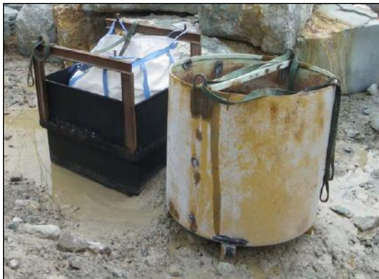
Foto 7-2. Esempio di vasche di raccolta dei fanghi di lavorazione con filo diamantato installate in un'altra cava.
