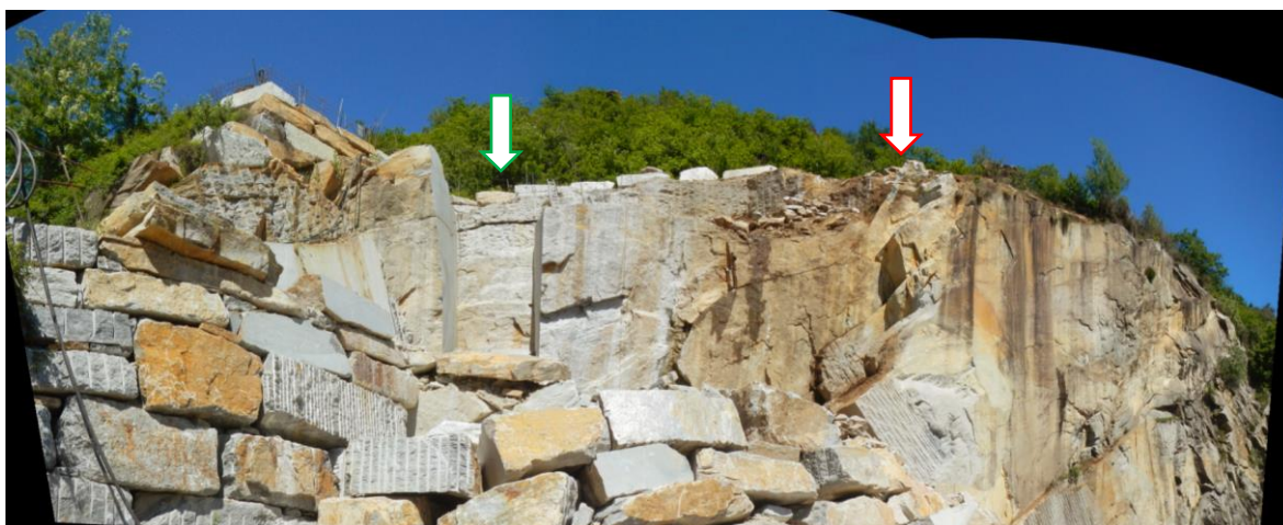
Foto 3-2. Vista frontale dal basso della zona di coltivazione. A sinistra, indicato dalla freccia verde, il “canale di apertura” del ribasso; più a destra, indicata dalla freccia rossa, la “zona critica” (descritta nel seguito) caratterizzata da piani di pioda più acclivi della norma.
