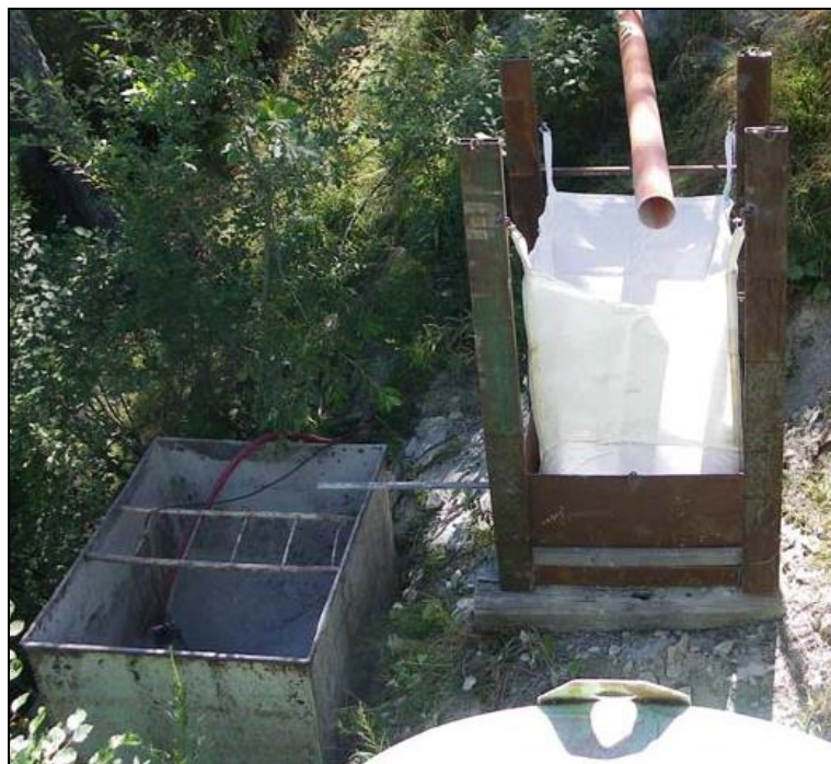
Foto 7-1. Esempio di vasche di raccolta per il riutilizzo delle acque di lavorazione, previa decantazione dei fini derivanti dal taglio con filo diamantato e dalla perforazione.
