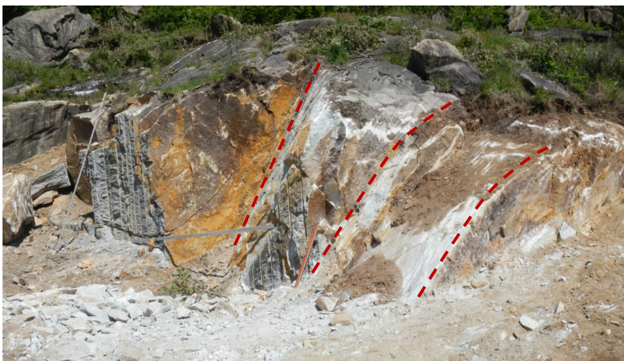
Foto 4-4. Vista ravvicinata della stessa zona. Le linee tratteggiate evidenziano come la “pioda” si incurvi ed aumenti la propria acclività, in corrispondenza del contatto fra il “verde argento” (a destra) ed il micascisto di tetto (a sinistra). Il fronte in primo piano corrisponde al settore II del rilievo geostrutturale, la parte sommitale al settore I, mentre a sinistra si intravede il fronte di coltivazione corrispondente al settore III.
