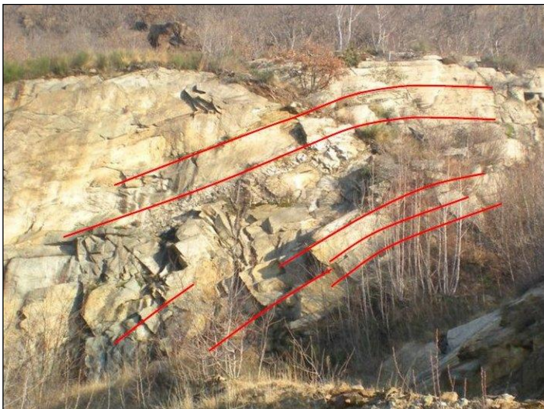
Foto 4-1. Versante dell'ammasso roccioso oggetto del rilievo geostrutturale mediante stendimento (in rosso è evidenziato il progressivo incurvamento del piano di "pioda", che comporta una giacitura più acclive nella parte inferiore del giacimento).
